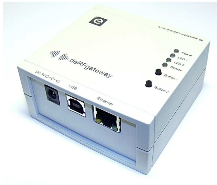
Fig. 3. Zigbee Gateway for Dresden Frauenkirche
